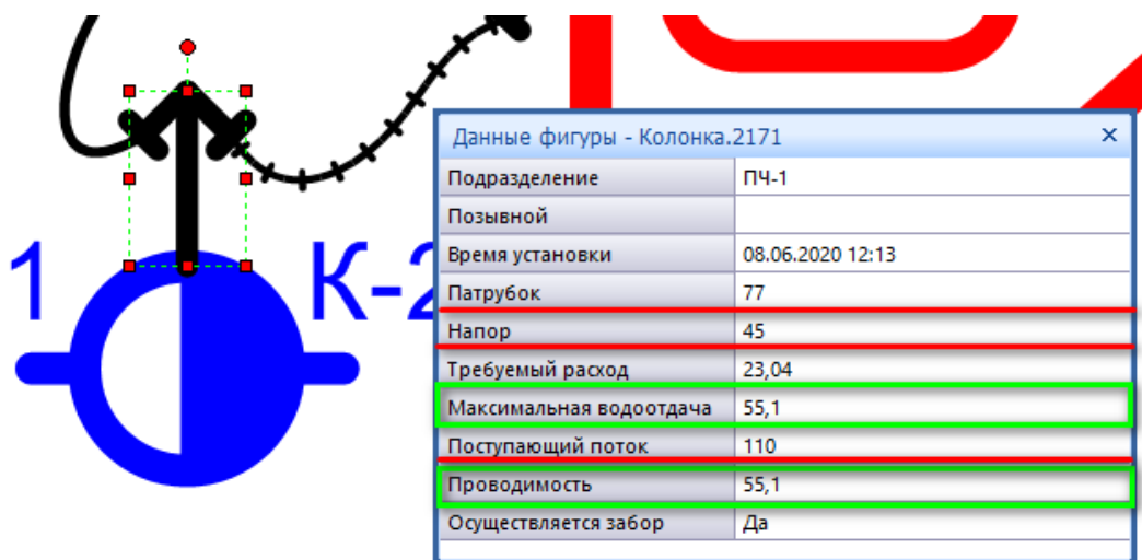
Рисунок 356 - Окно данных фигуры «Колонка». Зеленым выделены расчетные свойства. Красным выделены свойства влияющие на них
