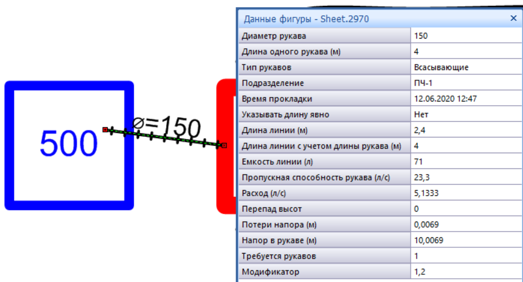
Рисунок 360 - Окно «Данные фигуры» всасывающей рукавной линии
